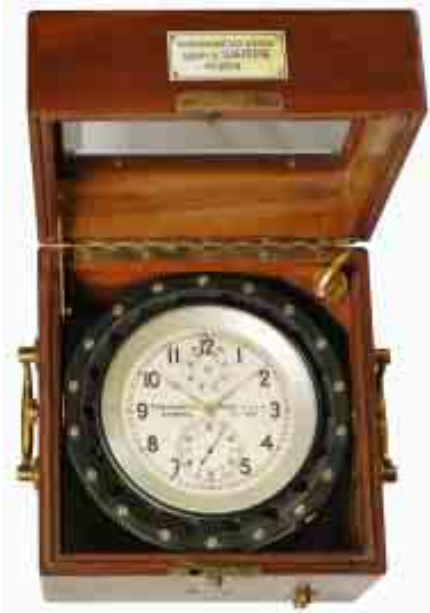
- links: Wempe, Chronometerwerke Hamburg, No. 2389, ca. 1940: Luftwaffen-Ankerchronometer, Gummiaufhängung, Unruhanhaltvorrichtung, Zeigerstellvorrichtung, 2-Punkt aufgehängtes, geschwärztes Messinggehäuse, 89 mm 4-Pfeilerwerk, Zahnfederhaus, Konstruktion nach Alfred Hellweg Deutsche Uhrmacherschule Glashütte, Aluminium-Bronze-Anker, Griesbach Unruh. Die Dienstvorschrift Luft 1255/2d zeigt das gleichartige Chronometer Wempe Nr. 2385. - Das Dokument, ein Rundschreiben von 1942 zeigt, dass von monatlich 40 Wempe Chronometern 15 für das RLM bestimmt waren.
